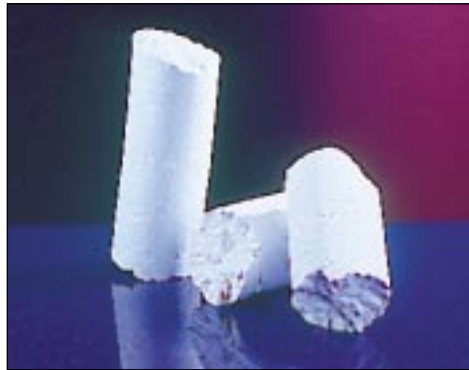
Emballages usagés en PSE compactes
