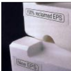
Polystyrène expansé recyclé. La qualité est identique à celle des produits créés à partir de matériaux neufs.
