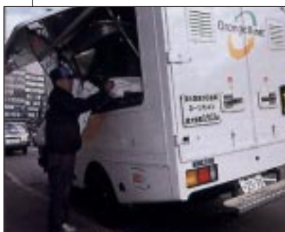
Pendant qu'un camion chargé de solvant limonène fait sa tournée des magasins d'électronique, le polystyrène collecté se dissout.
