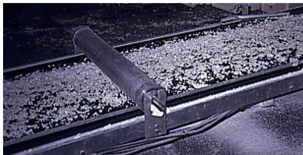
PSE densifié obtenu après le passage dans le tunnel de rétraction à infra-rouge
