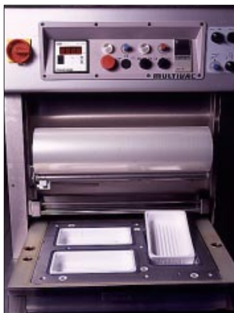
Emballages barrières permettant un conditionnement sous atmosphère modifiée, sous vide, ...
